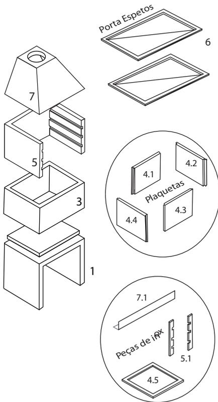
\*Coloque as peças, conforme está no desenho ao lado, no nível e no prumo com cimento cola ACIII.
