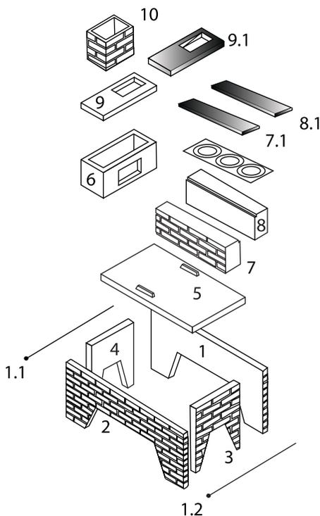
\*Coloque as peças, conforme está no desenho ao lado, no nível e no prumo com cimento cola ACIII.
